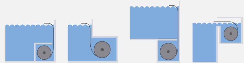
Unterflurabdeckung am Beckenboden
